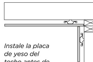
Instale la placa de yeso del techo antes de las paredes, uniendo la placa de yeso del techo a los pernos
